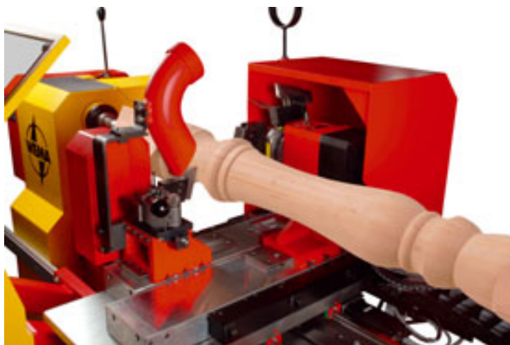
Drehen mit 2 Stählen Turning with 2 cutters Tournage avec 2 outils
