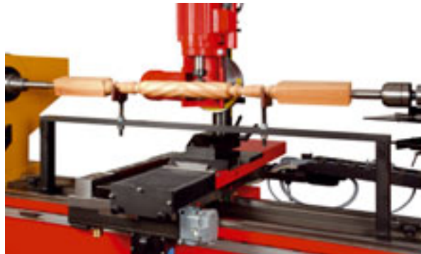
Abstützung mit 2 Stützböcken zum Fräsen dünner Werkstücke Steady for milling Lunette pour fraisage
