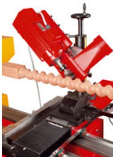
Fräsaggregat mit senkrecht eingestelltem Fräskopf Milling unit with vertical cutter head Dispositif de fraisage avec tête de fraisage verticale
